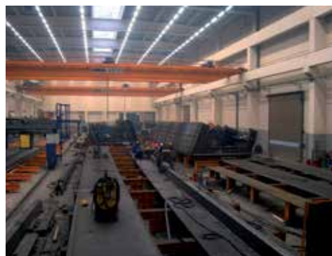
19 Vorfertigung der Hauptträger mit Doppelquerrahmen © Max Bögl Bauunternehmung GmbH & Co. KG
